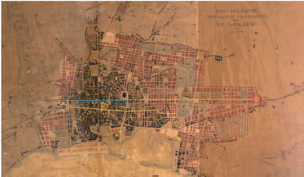
3_Felice Giarrusso e Ufficio Tecnico Comunale, Piano Regolatore e di Risanamento e Ampliamento della Città di Palermo , 1886 (Archivio Storico, Comune di Palermo). A colori sono stati sovrapposti i tracciati delle nuove strade: in celeste la via Maqueda (XVII sec.), in verde la via Ruggiero Settimo (XVIII sec.), in giallo la via Roma e la stazione ferroviaria (XIX-inizio XX sec.), in arancione la via della Libertà fino alla piazza circolare (XIX-XX sec.).
