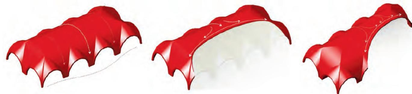
Fig. 9. Effetti prodotti sulle lunette dall'assettamento di una parete d'imposta e con interessamento dei muri d'angolo.
