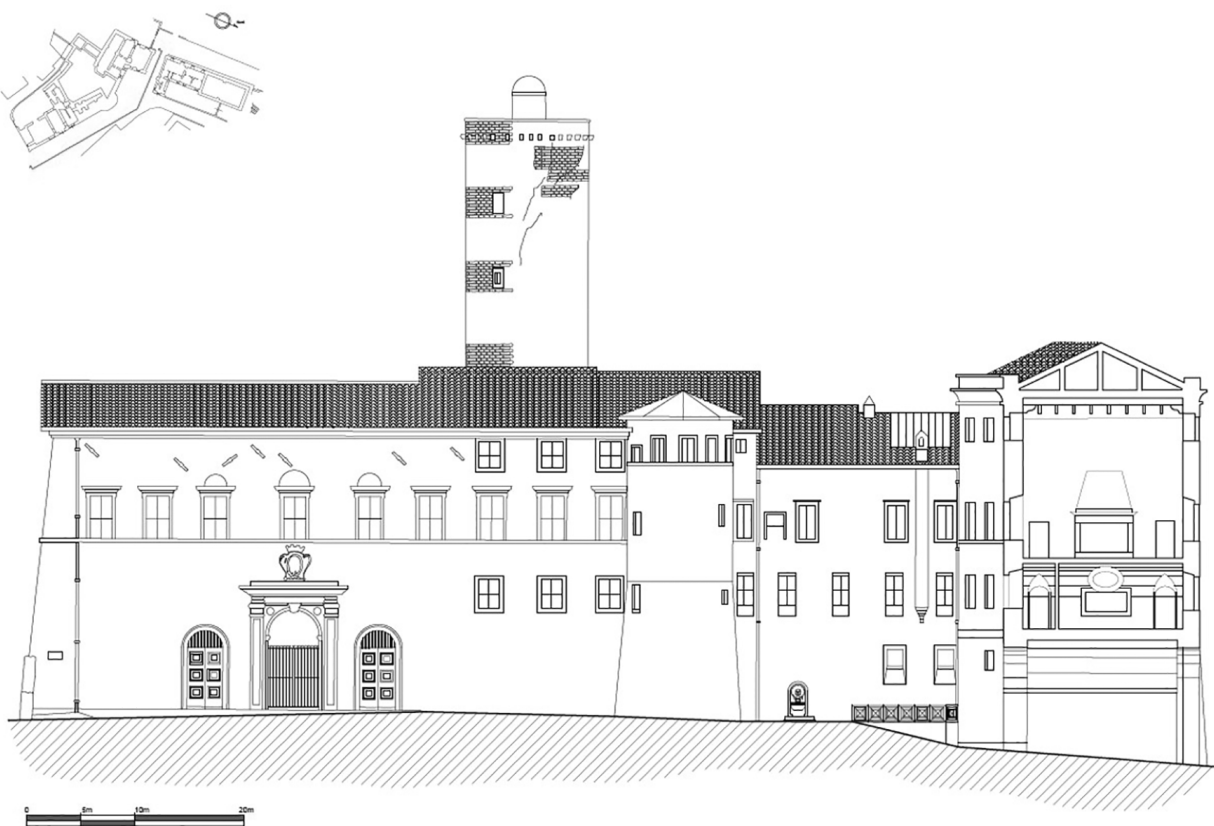
Fig. 5. Prospetto su via della Portella. In sezione gli ambienti della Sala Militare e della Sala degli Stemmati (restituzione grafica D. Calzolaio, 2019).
