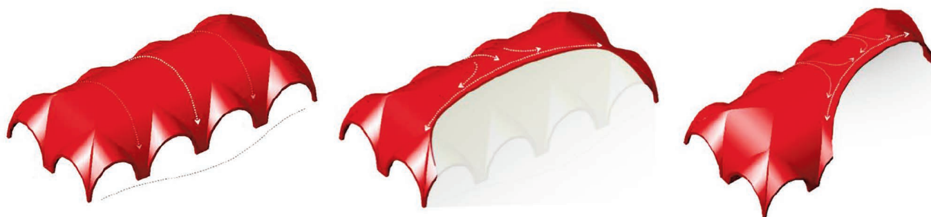
Fig. 9. Effetti prodotti sulle lunette dall'assettamento di una parete d'imposta e con interessamento dei muri d'angolo.
