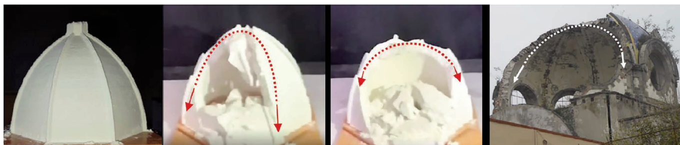
Fig. 12. Modello in scala di cupola poligonale di farina sottoposta ad azioni sismiche dinamiche, con fasi di collasso delle vele frontali e formazione spontanea di archi di riequilibrio, a confronto con il caso reale della cupola della chiesa di Nostra Signora degli Angeli a Città del Messico, colpita dal sisma del 17 set. 2017.
