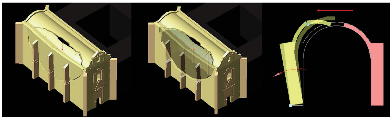
Fig. 6. Innesco ed evoluzione del cinematismo della volta a botte in una chiesa a navata unica con contrafforti laterali e d'angolo per effetto di azioni sismiche, con fenomeno di strappo e ribaltamento.
