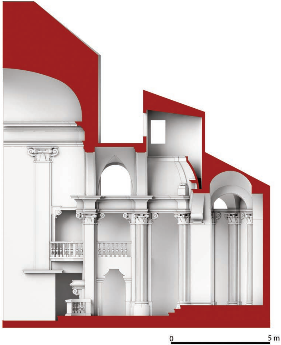
Fig. 84. Sezione longitudinale del modello digitale della tribuna della chiesa dell'Immacolatella a Trapani (elaborazione grafica di M. Cannella).
