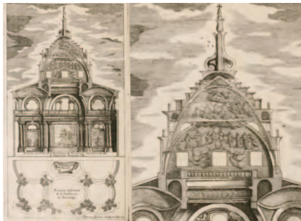
Fig. 43. G. Guarini, progetto per la chiesa di San Gaetano a Vicenza, sezione e dettaglio della cupola (da GUARINI, 1686, tav. 26).
