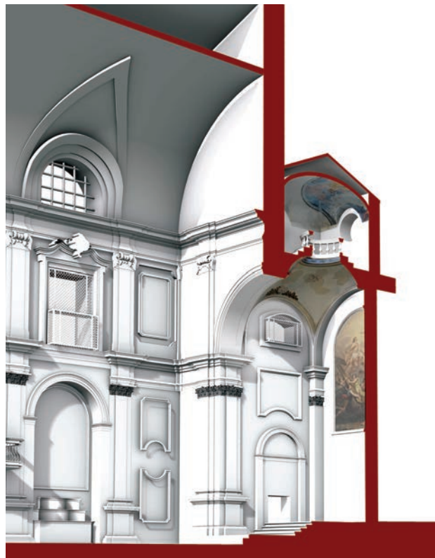
Fig. 4. Spaccato prospettico del modello digitale della Badia Nuova di Palermo, particolare dell'area presbiteriale (elaborazione grafica di L. Barrale).
