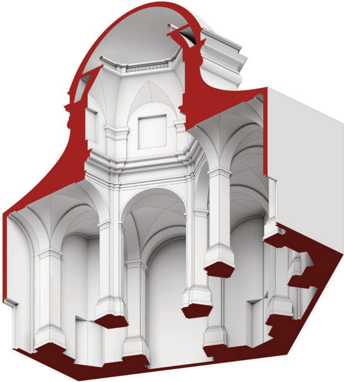
Fig. 74. Spaccato assometrico del Tempio a forma esagonale di Giovanni Amico (elaborazione grafica di M. Cannella).
