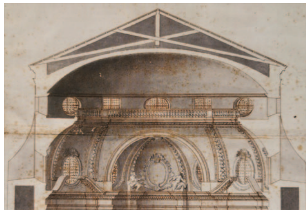
Fig. 65. A. Pozzo, progetto della chiesa di San Tommaso di Canterbury presso il Venerabile Collegio Inglese di Roma, sezione, dettaglio della copertura a camera di luce (Roma, Archivio del Venerabile Collegio Inglese, cartella “Pozzo”, n. 4 da BÖSEL, 2010).
