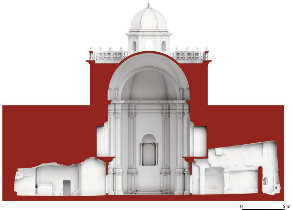
Fig. 44. Sezione trasversale della chiesa di Santa Maria della Grotta e degli ambienti ipogei situati ai lati della navata unica (elaborazione grafica di M. Cannella).
