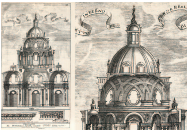
Fig. 33. G. Guarini, progetto per la chiesa di Sainte-Anne-la-Royale, sezione e dettaglio della cupola (da GUARINI, 1686, tav. 11).
