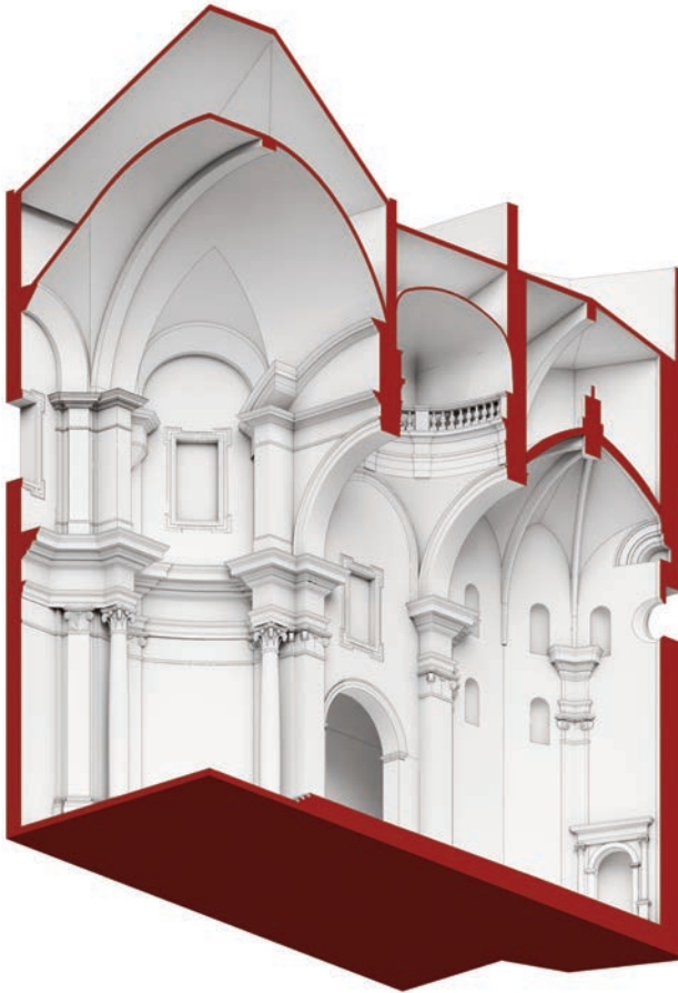
Fig. 86. Spaccato assometrico della tribuna della chiesa dell'Annunziata a Trapani: stato di fatto (elaborazione grafica di M. Cannella).
