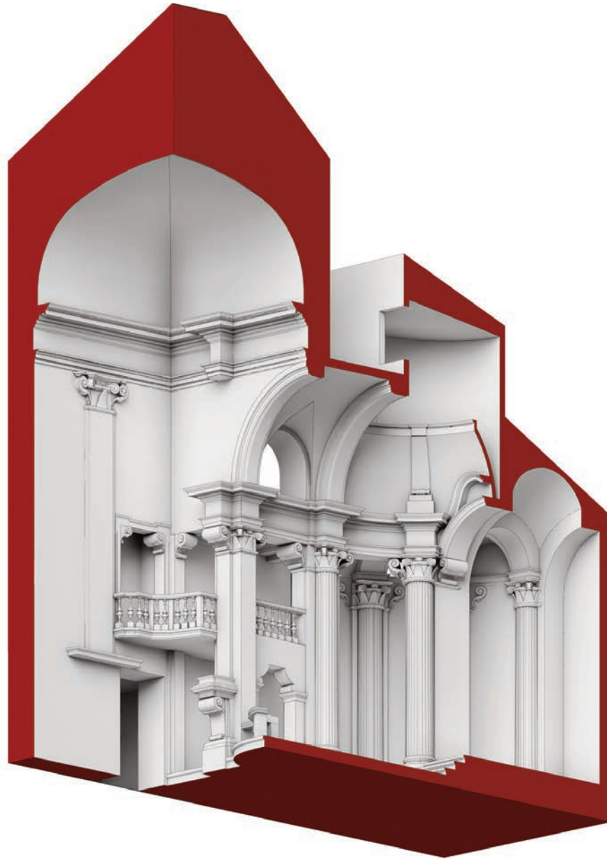
Fig. 60. Spaccato assometrico della tribuna della chiesa dell'Immacolatella a Trapani (elaborazione grafica di M. Cannella).
