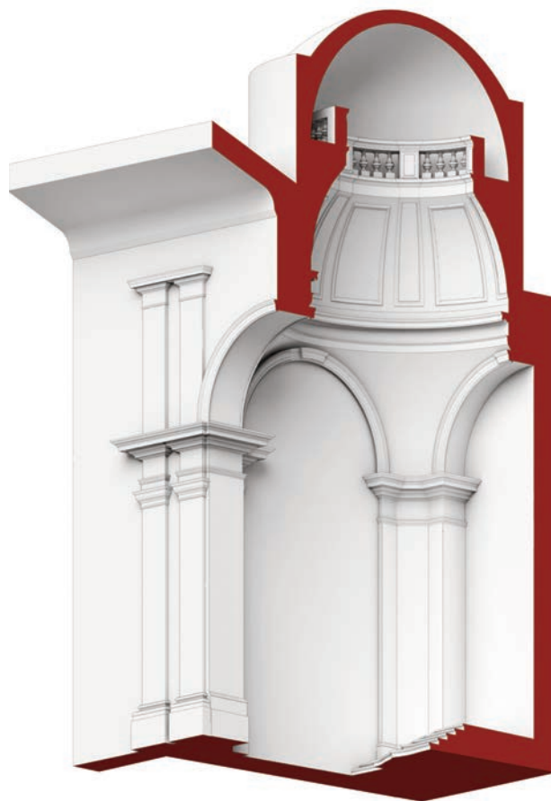
Fig. 72. Spaccato assometrico della cappella del SS.mo Crocifisso nella chiesa di San Domenico a Trapani (elaborazione grafica di M. Cannella).
