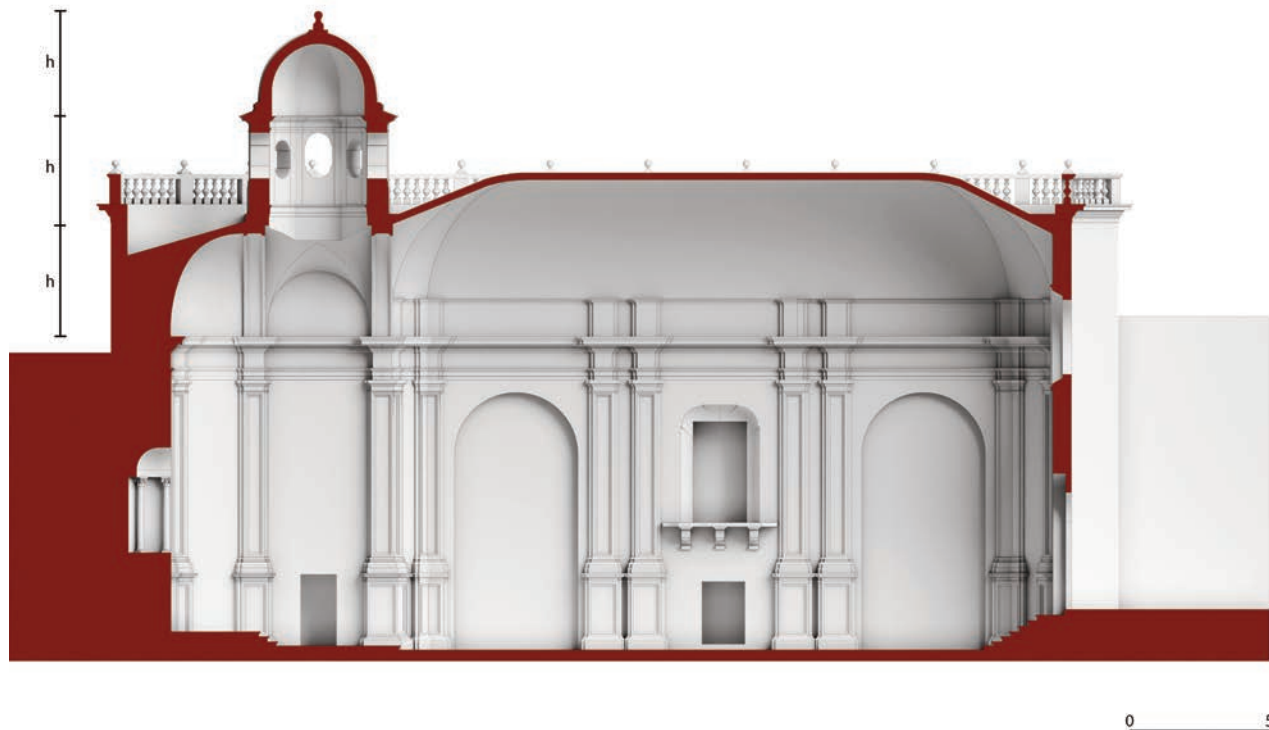
Fig. 47. Sezione longitudinale della chiesa di Santa Maria della Grotta a Marsala con indicazioni dei rapporti altimetrici che definiscono gli elementi costruttivi del sistema di copertura dell'area presbiteriale (elaborazione grafica di M. Cannella).
