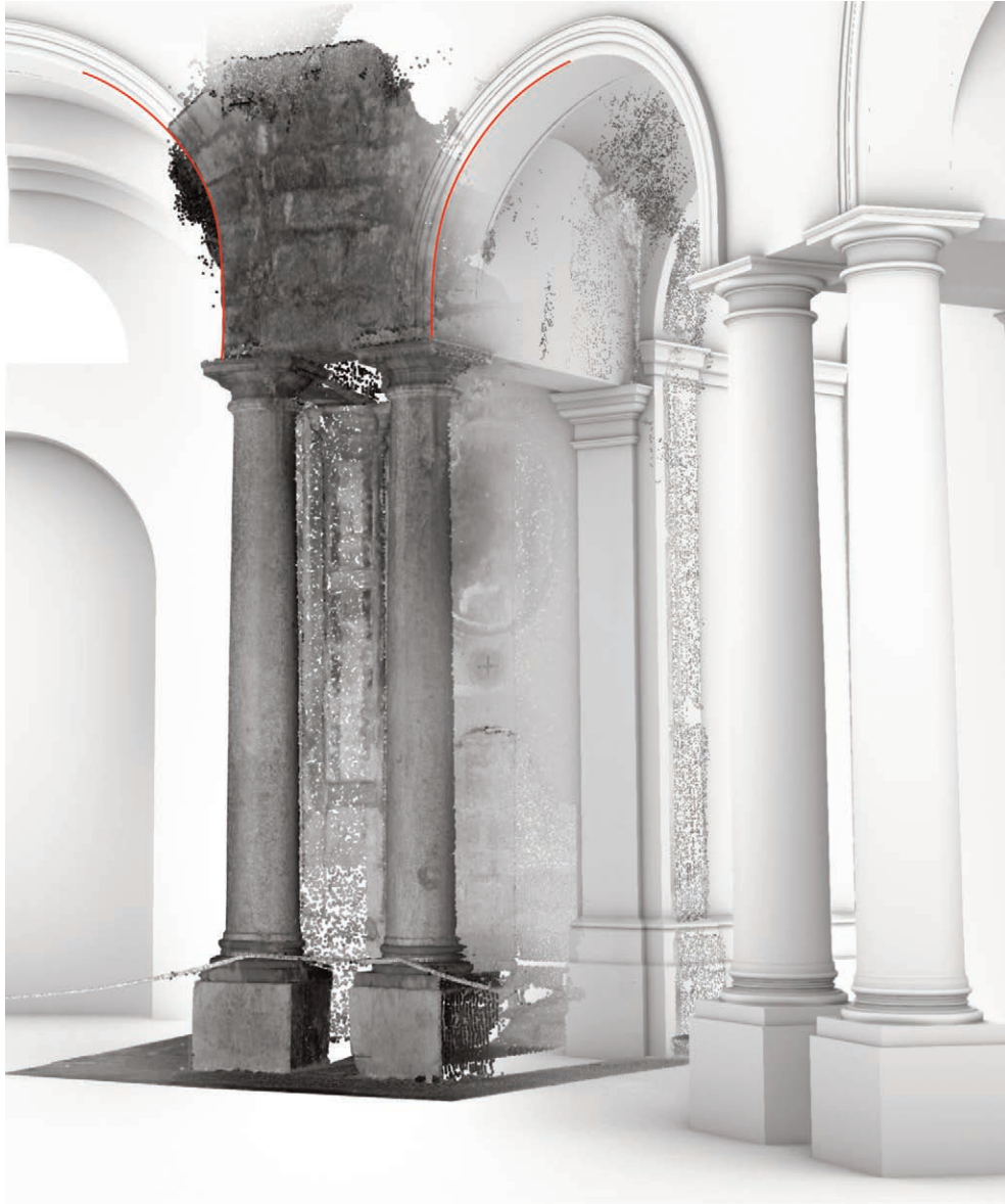
Fig. 16. Analisi della nuvola di punti, definizione delle geometrie delle circonferenze e ricostruzione virtuale degli archi delle serliane della chiesa di Sant'Ignazio a Mazara (elaborazione grafica di M. Cannella).
