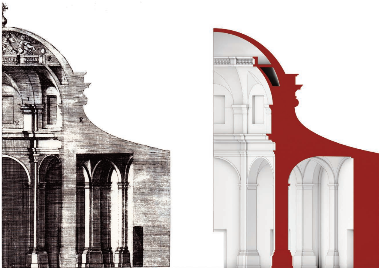
Fig. 8. G. Amico, Tempio esagonale . Confronto tra l'incisione (a sinistra) e il modello digitale (elaborazione grafica di M. Cannella).
