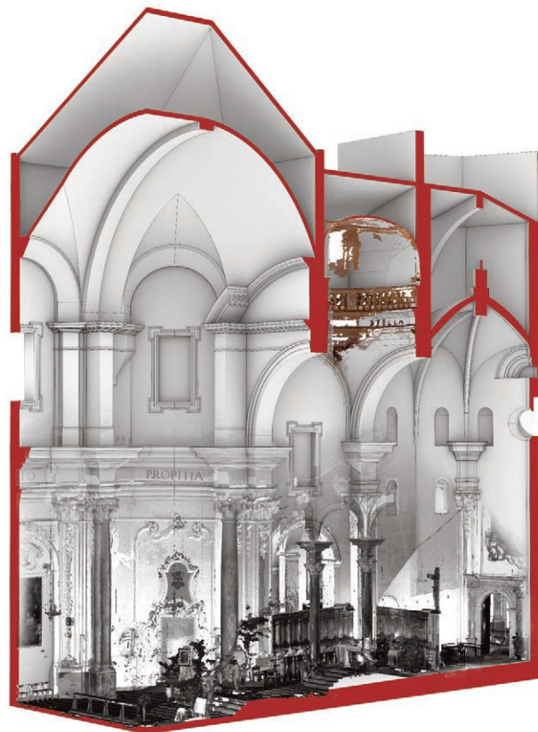
Fig. 3. Chiesa di dell'Annunziata a Trapani: rilievo laser scanning, fotogrammetrico e modello digitale (elaborazione grafica di M. Cannella).
