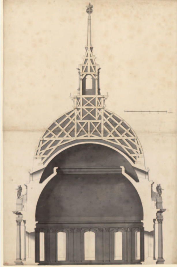
Fig. 47. Agende de Jules-Hardouin Mansart, Charpenterie du dosme des Invalides ; profil du dosme, maçonnerie et charpenterie, disegno a penna e inchiostro di china, lavaggio con inchiostro di china, 1688 (BnF, RESERVE HA-18 (C, 5)-FT 6, https://gallica.bnf.fr/ark:/12148/btv1b530375761 ).
