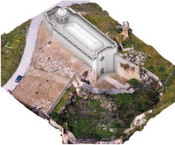
Fig. 4. Rilievo fotogrammetrico e modello digitale della chiesa di santa Maria della Grotta a Marsala (elaborazione grafica di M. Cannella).
