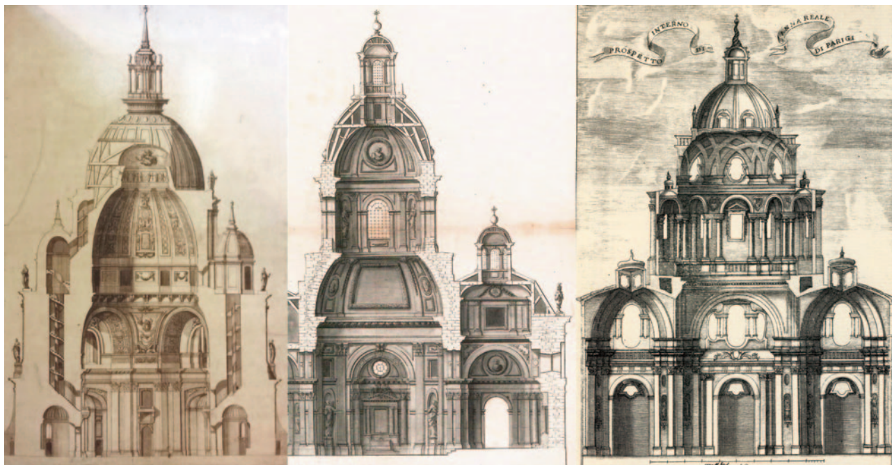
Fig. 34. Confronto tra tre soluzioni progettuali per la realizzazione del sistema di copertura a calotte multiple: da sinistra F. Mansart, (collaboratore), progetto per la cupola della chiesa di Notre-Dame-du-Val-de-Grâce, 1644 (BnF, Est Ha 18b, format 4); L. Le Vau, e F. d'Orbay, sezione longitudinale della chiesa del Collège Mazarin secondo progetto, 1665 (AN, M/176, pièce 32); Guarino Guarini, sezione trasversale della chiesa di Sainte-Anne-la-Royale (da GUARINI, 1686, tav. 11, elaborazione grafica a cura di G. Nuccio).
