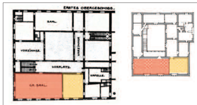
Fig. 2. Planta de la casa señorial de Alcocer, comparada con el Palazzo Medici de Florencia antes de la reforma del siglo XVII (reelaboración propia).
